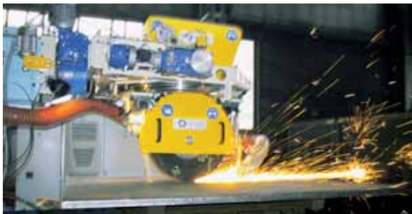
Multi-Schleifkopf für Schleifscheiben oder Schleifbänder Multi-purpose grinding head with grinding wheels or belts
