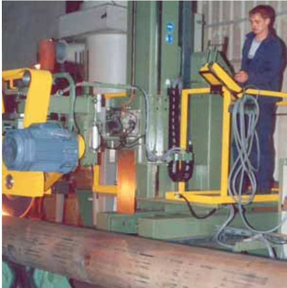
Schleifen der Wurzel an längs geschweissten Grossrohren Grinding of the roots on large pipes with longitudinal seam
