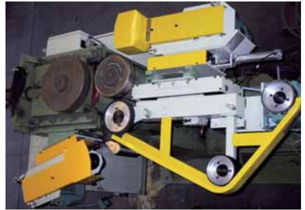
Angebauter Band- und Rotorschleifkopf zum Schleifen und Bürsten der Schweissnaht
